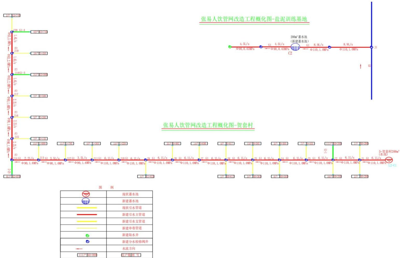
图 4.6-3 贺套村管网改造供水工程概化图
